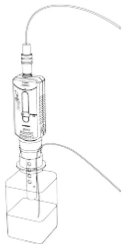
8. Placez le capteur de température à réponse rapide dans le flacon et assurez-vous que l'extrémité du capteur est couverte par l'échantillon de substrat.
