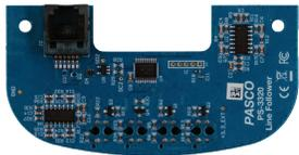
Le module de suivi des lignes permet au PASCObot de détecter et de réagir aux lignes personnalisées créées par les élèves à l'aide du ruban adhésif fourni.
